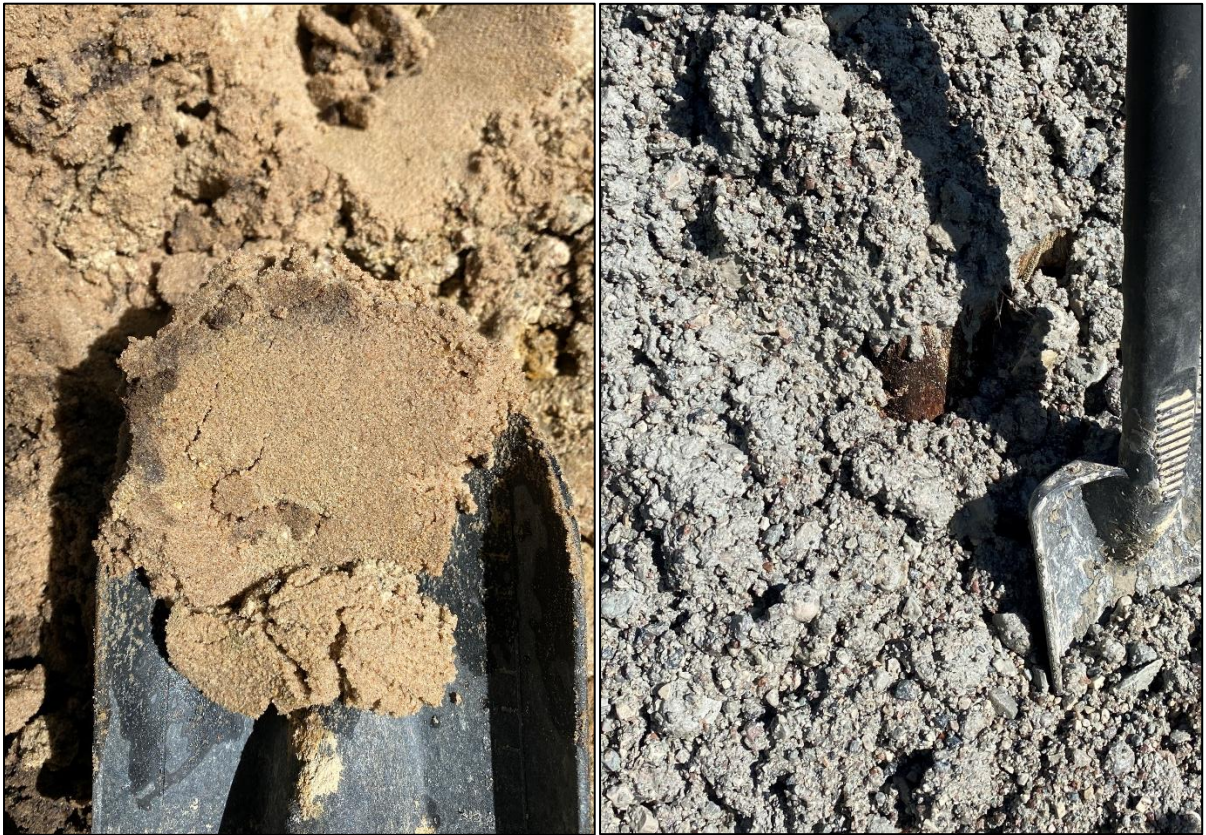
Fotod 5 ja 6: Kaevandi K05 ülaosas avanes ühtlase sorteeritusega keskmiseteraline liivakiht ning kaevandi K06 allosas ülijämedateralisest liivast ja peenkruusast koosnev lasund.
