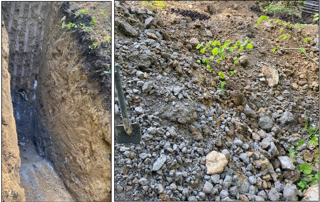
Fotod 3 ja 4: Kaevand K01 (sügavus pildistamise hetkel ca 5 m) ja selle materjal väljatõstetuna. Põhiliselt koosnes uuritav lasund pruuni tooni saviliivmoreenist, mis muutub sügavusega sujuvalt sinakashalliks.
